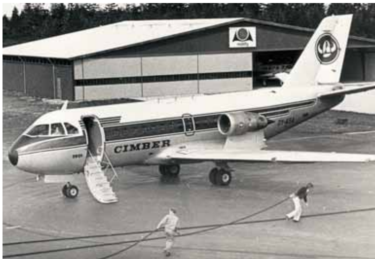
Der trækkes fuelslanger ud til Cimber Airs OY-ASA - en VFW-Fokker VFW-614. Flyet med plads til 44 passagerer var egentlig bygget til operationer på dårlige baner (motorerne var placeret højt, så de ikke sugede fremmedlegemer ind under start og landing). ASA blev sat i drift hos Cimber i 1976.
